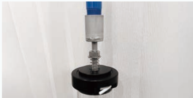
ヘッド部にハンドオーガーのロッドに直接取り付け可能な接手に加工
