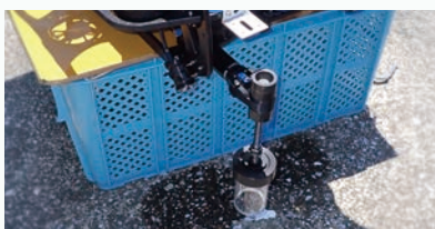
ロボットアームに柱状採泥器を装着
